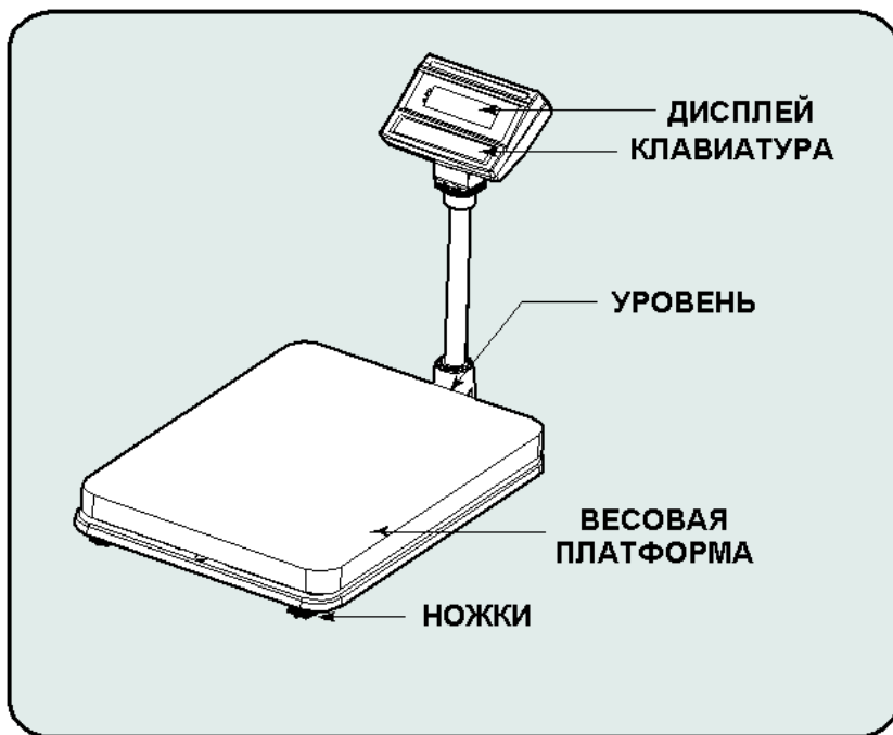
Рис. 5.1 - Внешний вид и основные элементы весов HD
